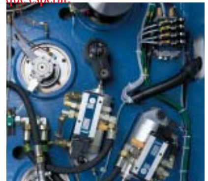
Unidades de válvula de cilindro para poner en marcha y parar los rodillos de impresión.
