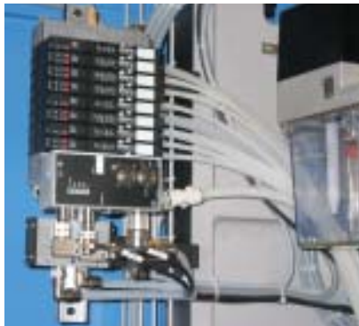
Control del accionamiento regulador (cilindros) a través del sistema portaválvulas HF03 con enlace de bus.
